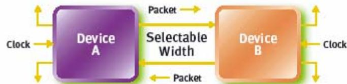
Una de las características muy atractivas del 3GIO es el hecho que el ancho de banda del enlace puede ser linealmente escalable agregando pares de señal formando múltiples caminos (lane). La capa física soporta los siguientes tamaños de caminos x1, x2, x4, x8, x12, x16, x32 dividiendo el byte de información como se muestra en la próxima figura. Esta información es dividida y re-ensamblada de forma transparente para las demás capas.
