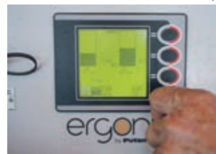
Das EPS-System ermöglicht das Einstellen des maximal gewünschten Hydraulikdrucks (und damit zwangsläufig auch des Betondrucks)
