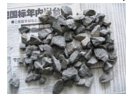
Eine völlig unausgeglichene Körnung war zunächst typisch für den Beton an der Sutong-Brücke
