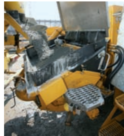
Mit dem 200 m 3 /h-Aggregat des BEKA M 62-6 lässt sich „richtig Menge“ pumpen!
