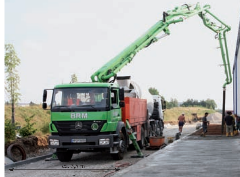
Die Fahrwegbreite reicht dem M 20-4 zum Abstützen
