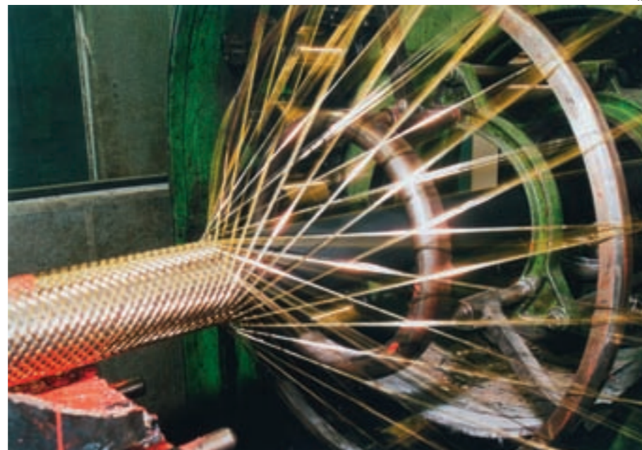
Das Flechten der feinen Stahldrähte um die Schlauchseele ist aufwändig und setzt die richtige Technik voraus
