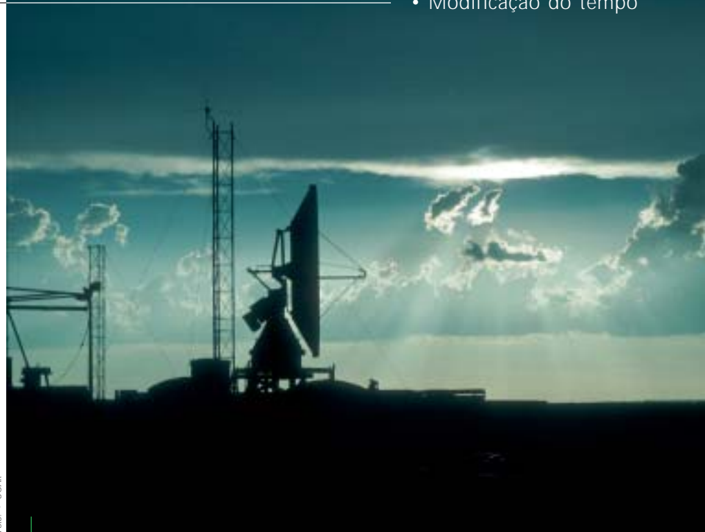
Radares Doppler móveis são usados para recolher dados sobre a velocidade do vento e precipitação para um projecto de pulverização de nuvens.
