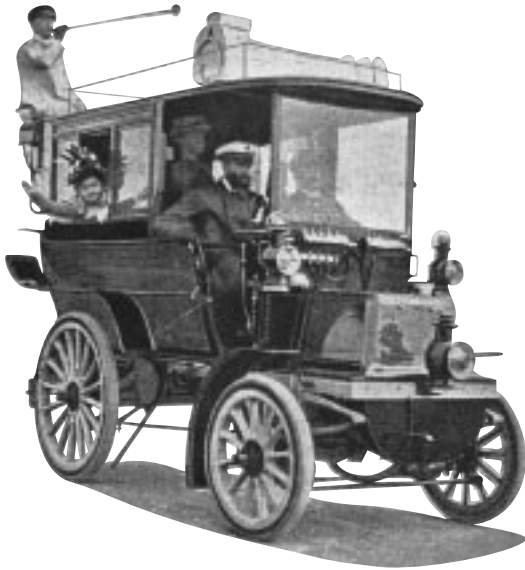
Wagen von Panhard & Levassor, ein sogenannter „Break“. Das Unternehmen galt damals als die führende Motorwagenfabrik in Frankreich. Der Ruf der Fahrzeuge, die unter anderem die großen Wettfahrten Paris–Bordeaux (1895) und Paris–Marseille (1896) gewonnen hatten, gründete wohl zu einem nicht geringen Teil auf dem Einsatz von bewährten Daimler-Motoren.
