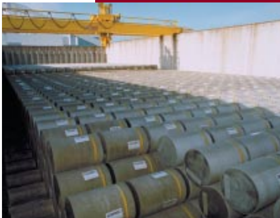
ADT, entreposage de fûts CO et C1 en provenance de l'atelier AD2 COGEMA La Hague
