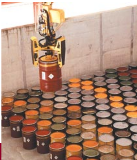
Stockage de fûts métalliques (Centre de stockage FMA de l'Aube)
