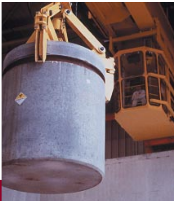
Dépôt d'une coque béton dans une alvéole (Centre de stockage FMA de l'Aube)
