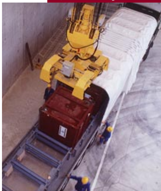
Déchargement d'un caisson métallique (Centre de stockage FMA de l'Aube)
