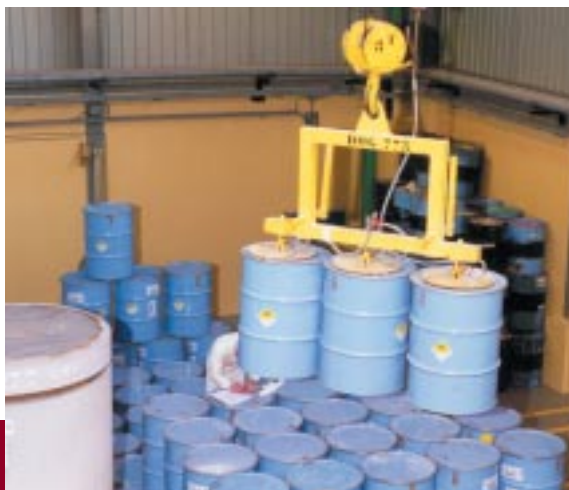
Fûts de déchets et coques de déchets cimentés
