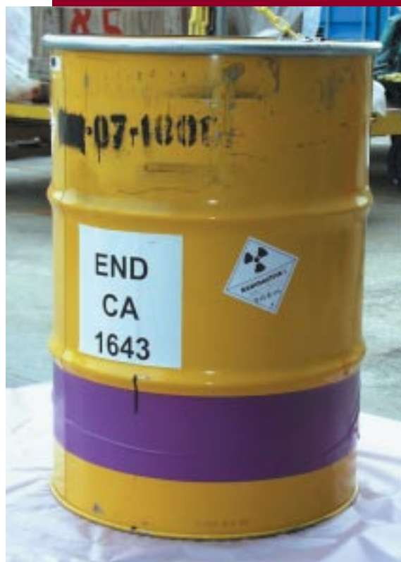
Fût métallique de boues et concentrats cimentés
