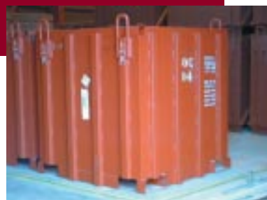
Caisson métallique contenant des déchets cimentés
