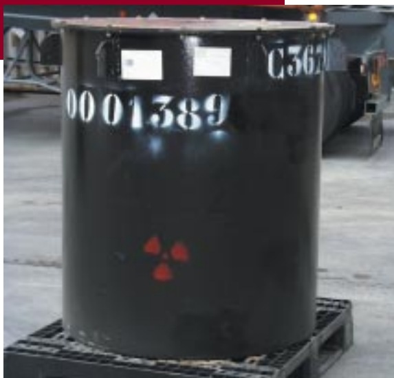
Fût de 870 litres de déchets cimentés
