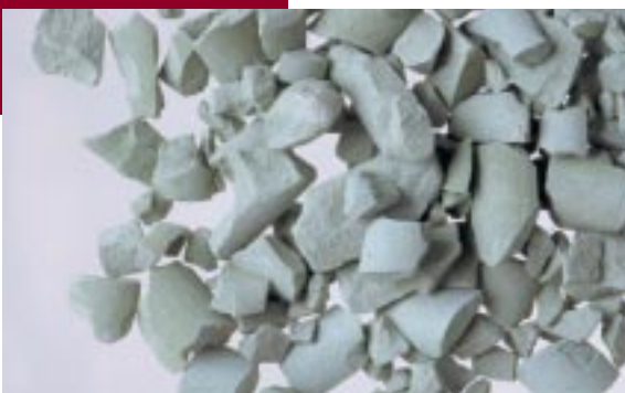
Cristaux d'UF 4 (tétrafluorure d'uranium)
