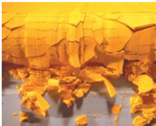
Concentré d'uranium yellow cake sur filtre à bande
