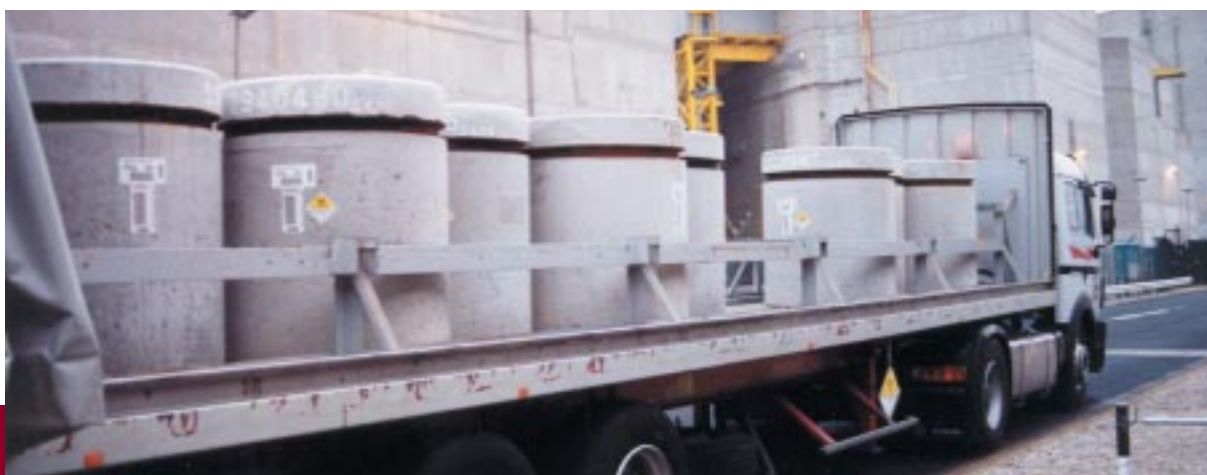
Coques béton de déchets cimentés
