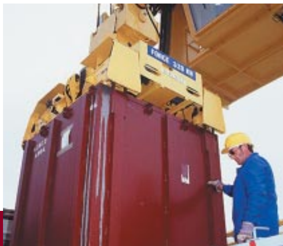
Caisson métallique de déchets cimentés
