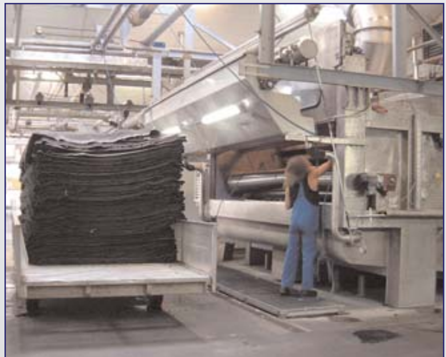
«Novacarp» mit Heißausfahrvorrichtung. Kein Nachziehen der Färbung. Nach dem Heißausfahren liegt der Teppich wie gemustert auf dem Abtafelwagen.
