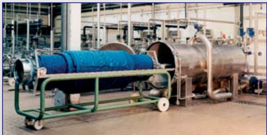
Beladen des «Turbostat H» mit einem Färbebaum
