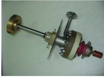
Рис. 2. Импульсный магнит с охлаждением и термостабилизацией жидким азотом на поле 40 Тл (длительность импульсов 2,5 мс). Импульсный гиротрон на частоту генерации 1 ТГц.
