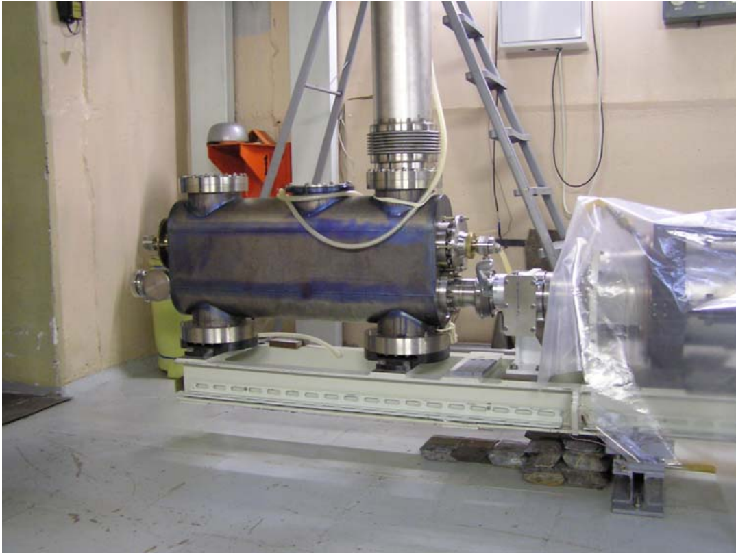
Рис. 3. Начальная часть канала. Сферическое зеркало, преобразующее расходящийся пучок излучения в параллельный, находится внутри корпуса из нержавеющей стали. В том же корпусе расположено плоское зеркало, направляющее пучок вверх.
