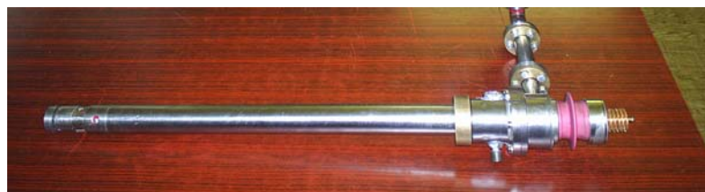
Рис. 6. Схема и фото двухрезонаторного гироумножителя с самовозбуждающейся входной секцией.
