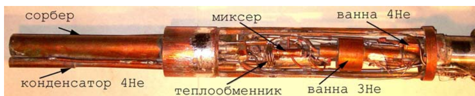
Рис.3. Низкотемпературная часть криостата со снятыми экранами и корпусом.
