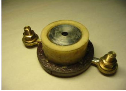
Рис. 2. Импульсный магнит с охлаждением и термостабилизацией жидким азотом на поле 40 Тл (длительность импульсов 2,5 мс). Импульсный гиротрон на частоту генерации 1 ТГц.
