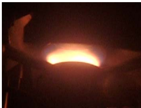
Рис.2. Фотография разряда над подложкой при давлении газовой смеси 150 Торр.
