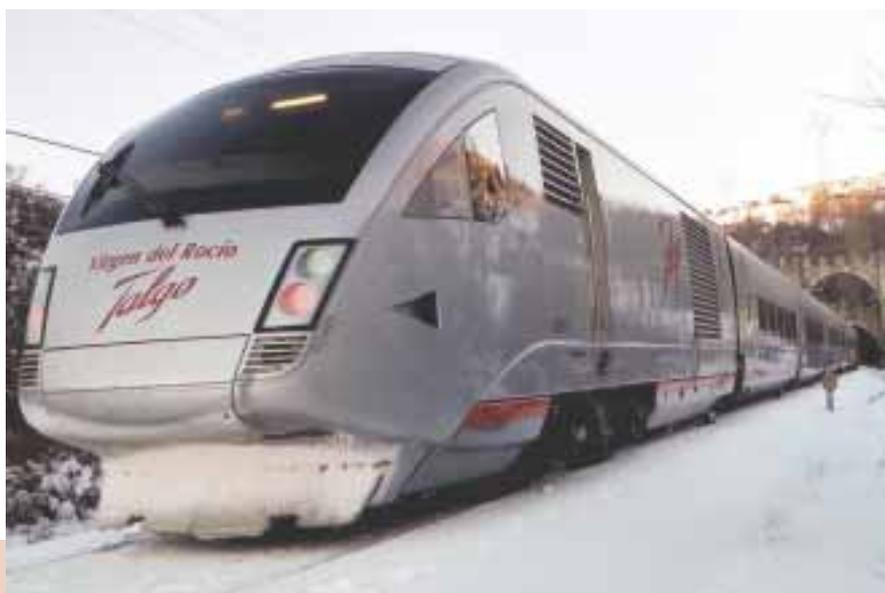
Bild 12: Diesel-Triebkopf
