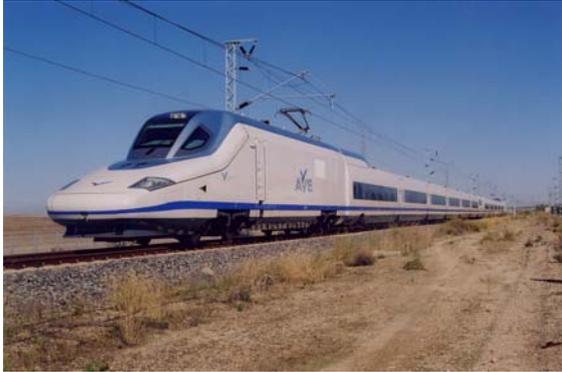
Jeder der 200 m langen Triebzüge wird über zwei Triebköpfe und 12 Mittelwagen verfügen. Die Traktion erfolgt durch Asynchronmotoren in Verbindung mit IGBT-Umrichtern; beim Bremsen wird prioritär die Netzurückspeisung genutzt. Bezogen auf die Leermasse des Zuges ergibt sich aus der Leistung von 4.000 kW je Triebkopf ein spezifischer Wert von etwa 25 kW/t.
