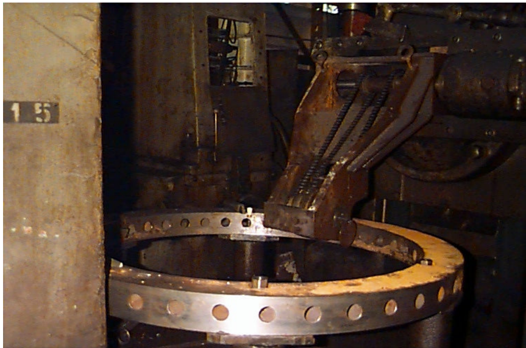
5.2. ábra. A hordócsiga megmunkálása
