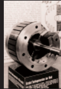
Premier rotor cylindrique pour un turbogénérateur, 1901
