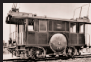
Burgdorf-Thun-Bahn 1899, erste Drehstrom-Vollbahn der Welt
