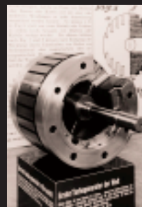
Erster zylindrischer Rotor für einen Turbogenerator, 1901
