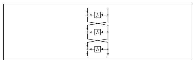
**Fig. 6.** Feistel Scheme  $\Psi(f_1, f_2, f_3)$ .
