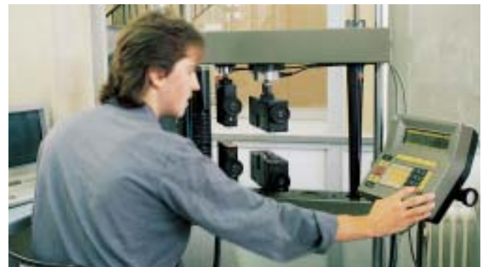
Vernetzter Prüfplatz Integrated testing machine
