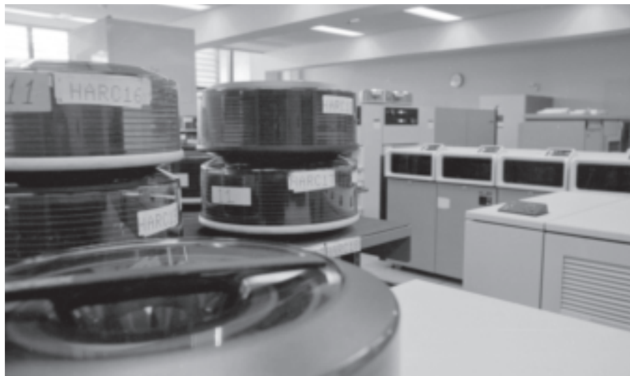
Monterbare pladepakker. Sidst i 1970'erne var den gængse model IBM3330, hvor sådan en spindel kunne indeholde 110Mbyte.
