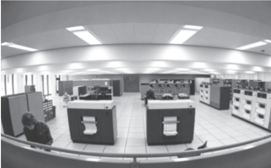
Mellem bygn. 305 og bygn. 321 blev der i kælderplan indrettet en prestige-præget maskinstue, der stod klar i 1972. Maskinen var nu en IBM 370/165, der havde virtuelt lager. Billedet er taget fra det sted, hvor brugerne med et rækværk som eneste adskillelse kunne stå og tage det hele i øjesyn.
