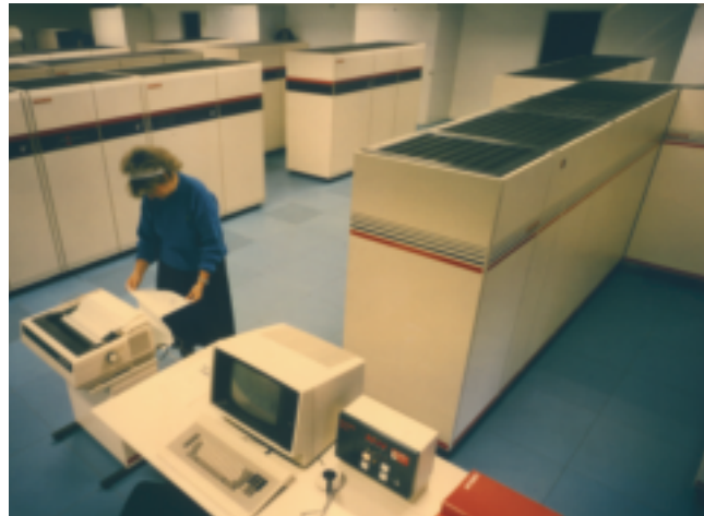
Danmarks første supercomputer, vektorprocessoren VP1100 fra Amdahl. Lageret var på 128 Mbytes og peak performance var 286 Mflops.
