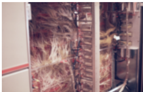
Trådning på bagsiden af processoren – CPU'en. I dag fås CPU'er på en enkelt VLSI-Chip.
