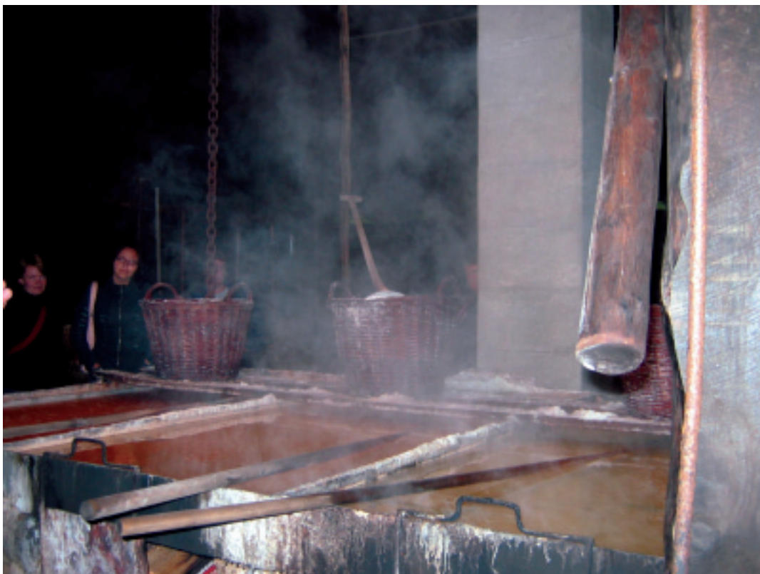
Figur 1. Saltsydning på Læsø. Saltlagen inddampes ved ca. 80°C.
