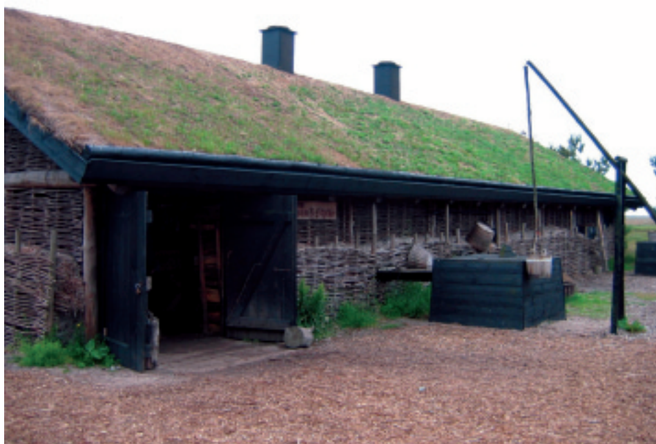
Figur 3. Vippebrønd på Læsø. Oppumpningen af det stærkt saltholdige grundvand foregår, som dette museumsstykke viser.
