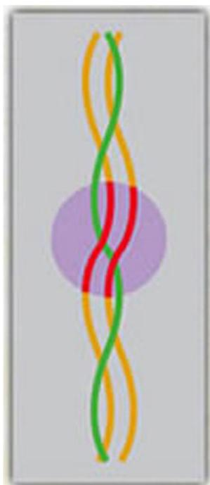
**LINHA DE COSTURA** - composta por três fios de alta qualidade, sendo um fio na cor verde e dois na cor amarela, estes últimos com luminescência vermelha sob a ação dos raios ultravioleta.
