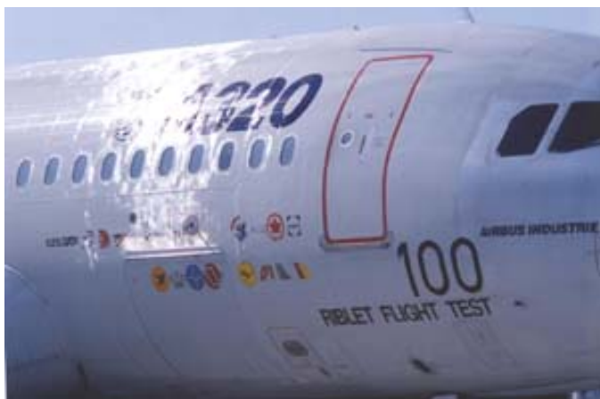
Abbildung 8: Ribletfolie an A320 von 3M
