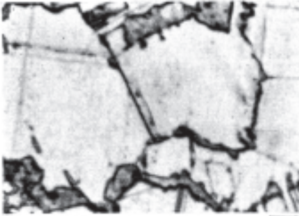
Abb. 20. V = 500:1 Silber-Kupfer-Legierung mit 93,5% Silber. Gewalzt und geglüht.
