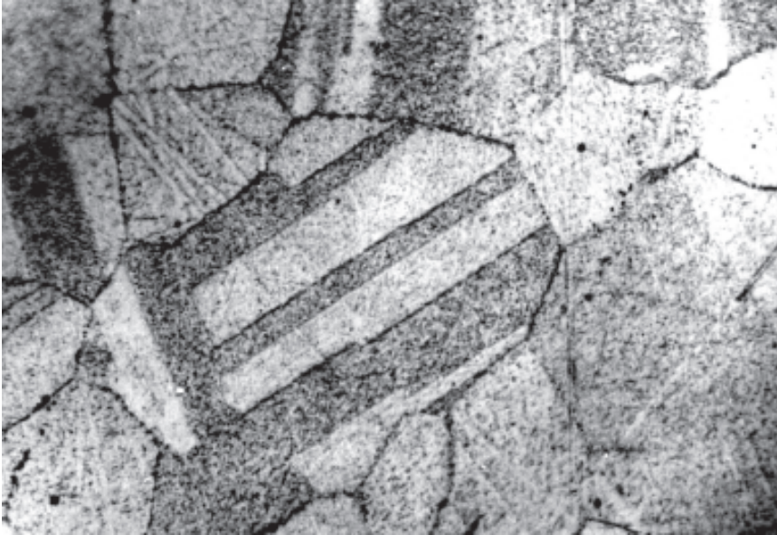
Abb. 2/9 Probe Hamig geätzt 1000-fach vergrößert. (Montanuniv. Leoben)
