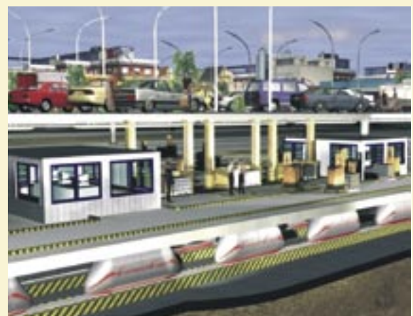
Verladestation des CargoCap: Die Vision zeigt die unterirdische Verladung von Europaletten in die Transportkapseln des CargoCap, während „oben“ der Verkehr ungestört weiterrollt.
