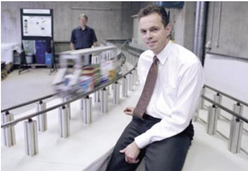
Abb. 7: Weiche im Test: Auf dem Modellprüfstand wird ein maßstabsgerechtes Modell der Kapsel durch einen Elektromotor angeschoben. Mit einer Zielgeschwindigkeit von 18 km/h - der Hälfte dessen, was für eine vollständige dynamische Ähnlichkeit erforderlich wäre - saust die Kapsel über die Teststrecke. Juniorprofessor Dr.-Ing. Jan Scholten (r.) und Dipl. Ing. Lutz Hohaus überwachen den Versuch
