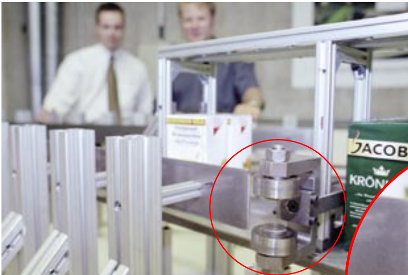
Abb. 4: Die neue Weichentechnik umgesetzt für den Modellprüfstand. In die an der Rohrwand befestigte Führungsschiene „fädelt“ sich ein seitlich an der Transportkapsel befindlicher Führungsarm ein.
