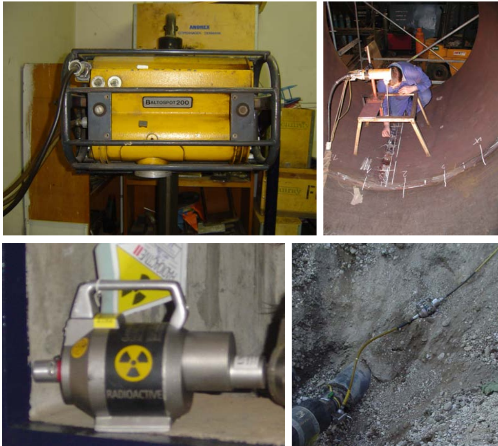
Slika 11: Industrijska radiografija: rentgenski aparat in defektoskop; uporaba.
