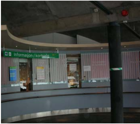
Figur 7.20 Søylen mellom hovedinngangen og billettluke har en uheldig plassering for blinde og svaksynte.
