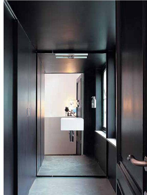
Pour gagner de la place dans les toilettes, le mur-miroir du fond est pivotant : derrière sont dissimulées diverses fonctions. Ingénieux et très esthétique.
