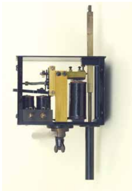
Sommatore elettrico di impulsi.
