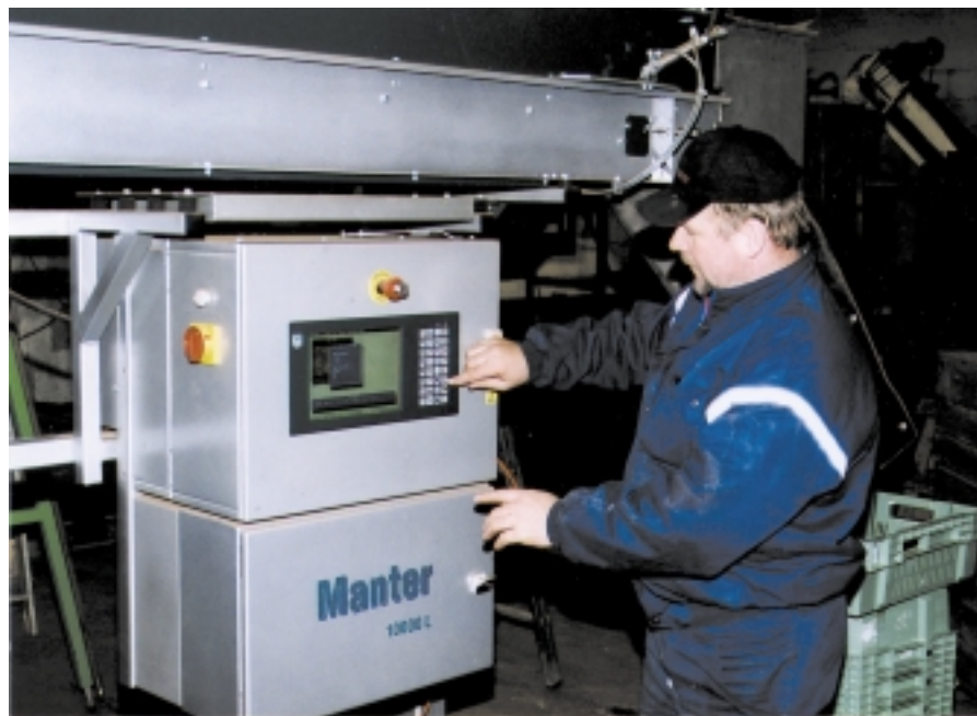
Pakkauskoneessa on runsaasti työtä auttavaa tietotekniikkaa. Se laskee kilot ja pakkaukset. Tuomo Peltola asettaa tunnusluvut.
