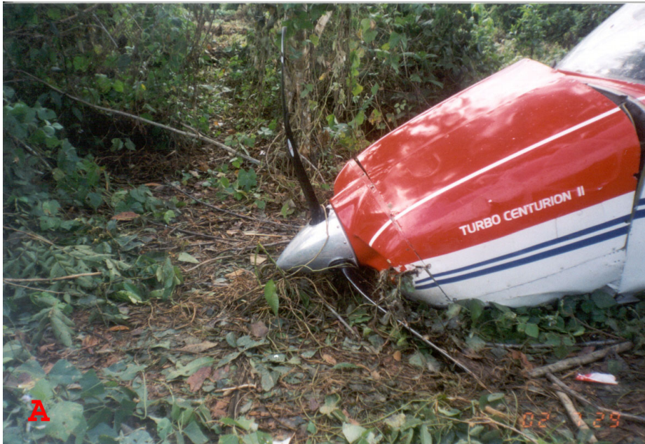
A y B. Hélice recta sin signos de doblez o "twisting" al momento del impacto.
