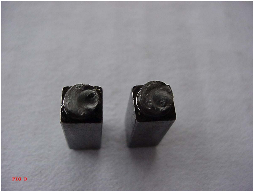
FIG D detalle de ambas partes rotas del coupling.
