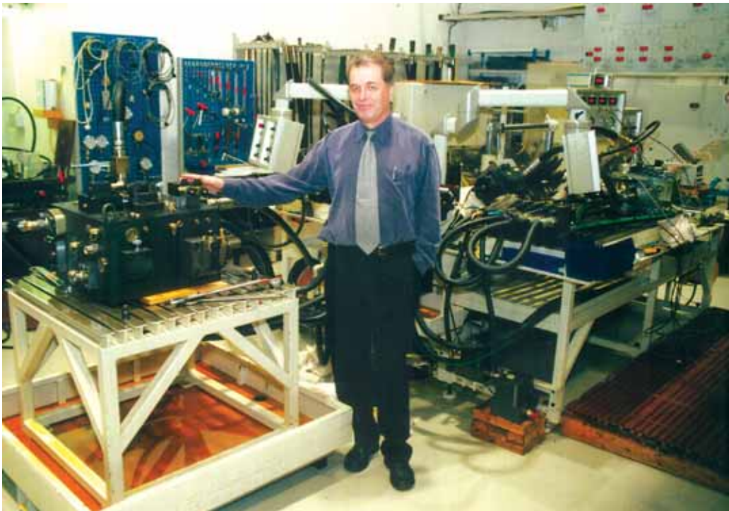
Denison Lokomec pyrkii toimittamaan lohkot valmiina, jolloin ne voidaan asentaa suoraan koneisiin. Testipenkeissä komponentit säädetään toimimaan tavoitteiden mukaisesti.
