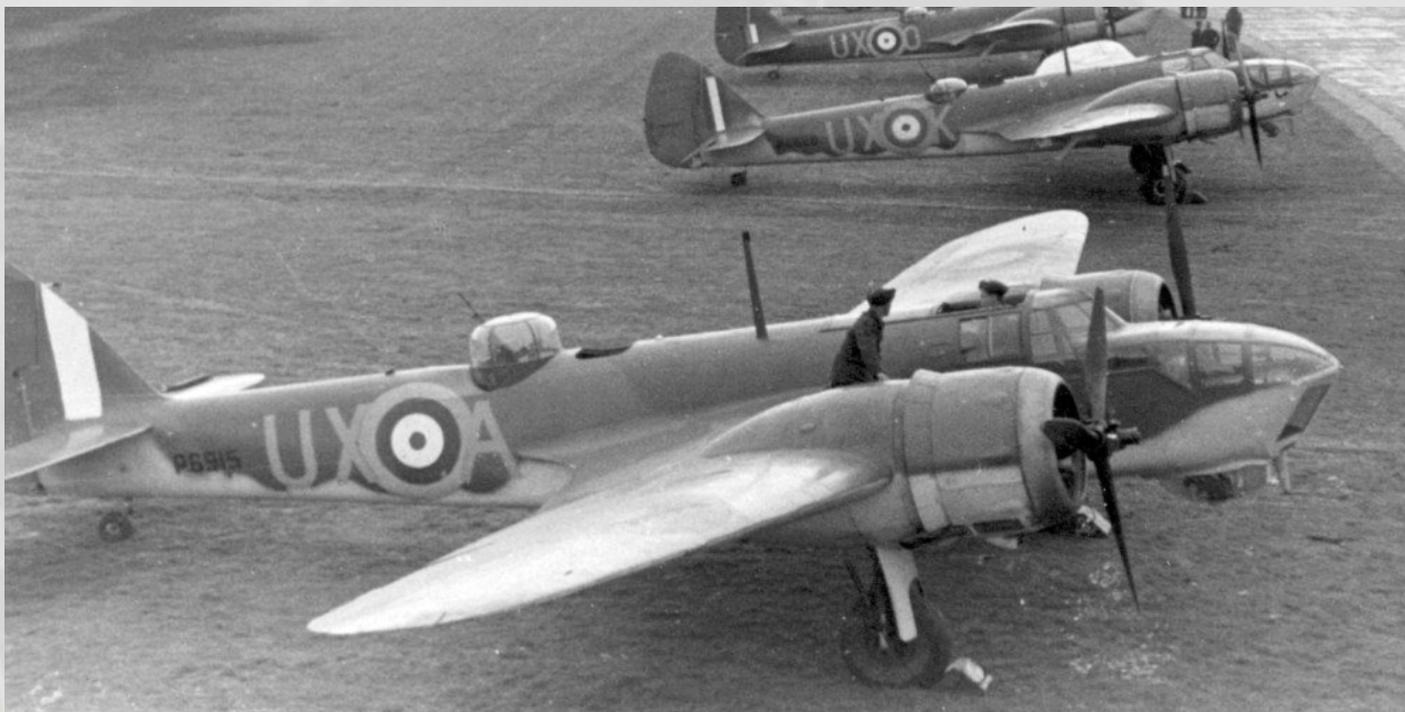
**El Bristol Blenheim era un bombardero diurno ligero diseñado a mediados de los años 30. Estaba equipado con una ametralladora en el morro, dos en una torreta ventral y dos en una dorsal, las 5 de 7.7 mm. Podía transportar cuatro bombas de 110 kg. o 2 de 230. Se empleó en combate hasta 1943, ya que por entonces la mayoría de los cazabombarderos podían portar una carga útil de bombas similar a mucha mayor velocidad**
