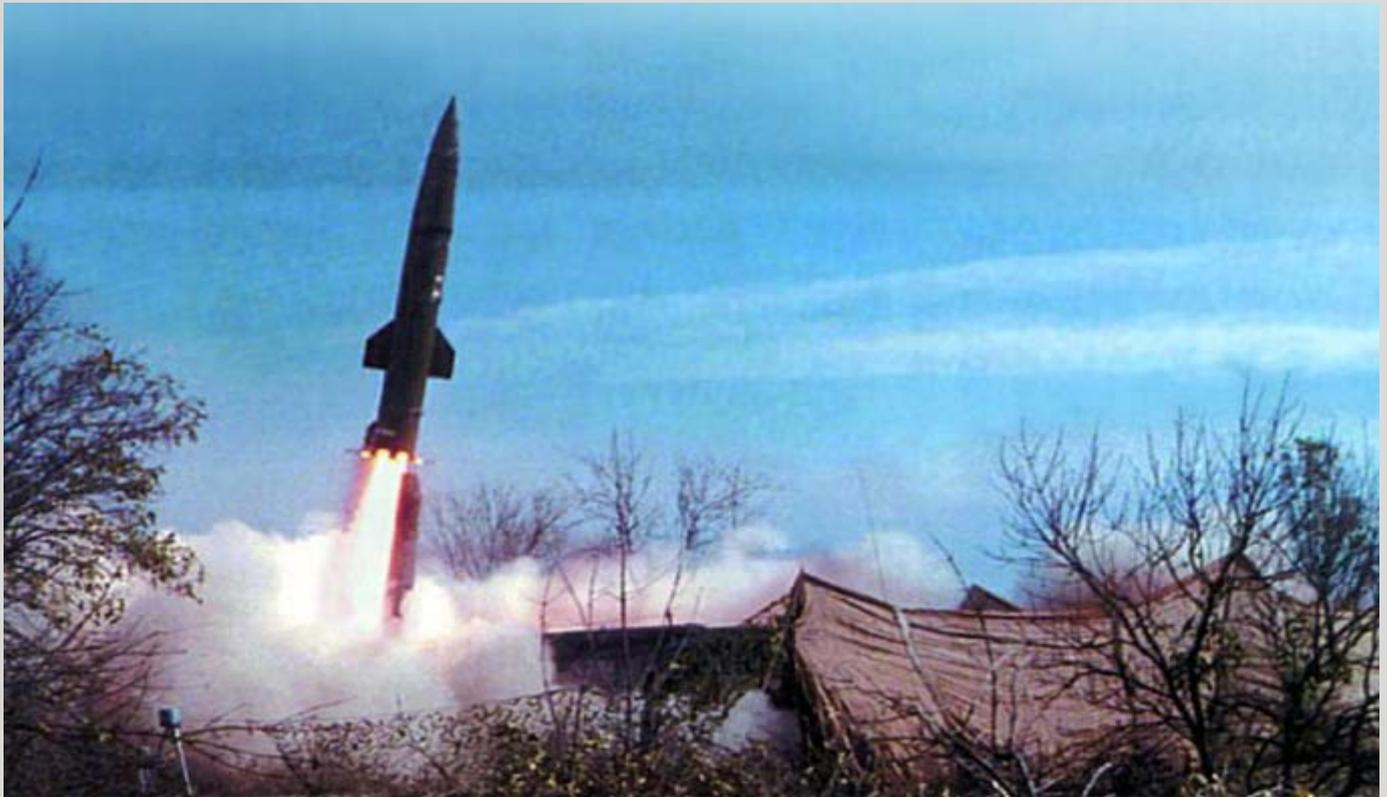
UN MISIL RUSO SS-26 "SCARAB" ES LANZADO EN LAS CERCANIAS DE GROZNY. EL SCARAB ES UN MISIL TACTICO BALISTICO DE CORTO ALCANCE , PENSADO PARA SER TRANSPORTADO POR CARRETERA HASTA LA ZONA DE OPERACIONES Y REALIZAR ATAQUES A DISTANCIAS DE HASTA 100 KIM, CON CARGA NUCLEAR O CONVENCIONAL
