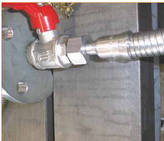
Bild 4. Einsatz von druck- und temperaturbeständigen Schläuchen zum Entleeren
