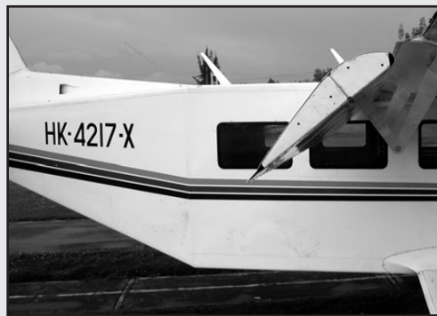
Volets : cambrure et déflexion maximale
