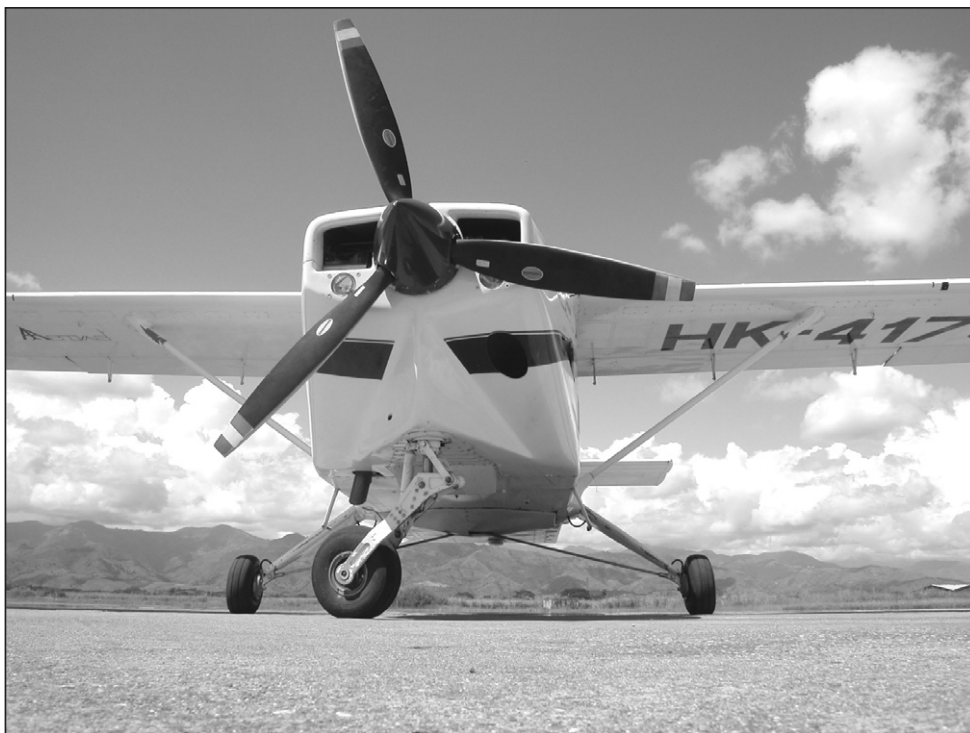
Capot, en composites, intégrant deux puissantes optiques de phare
