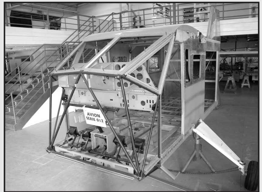
Fuselage : solide construction, en tubes d'acier soudés
