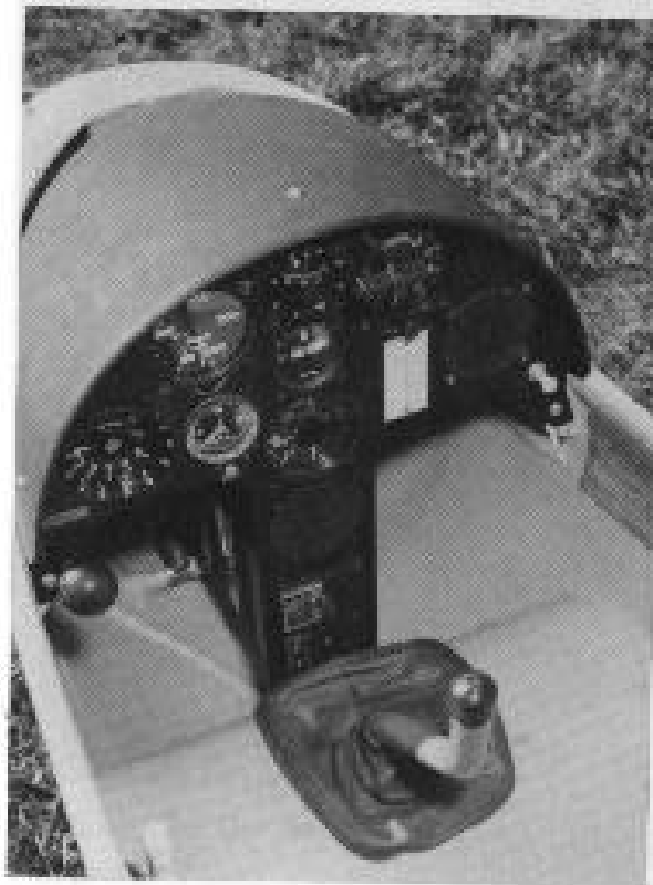
Instrumentenbrett, Bedienhebel und Steuerknüppel des Phoebus.
