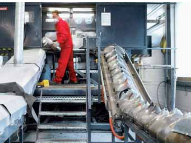
In unserem Rückbauzentrum folgt auf die teils manuelle Demontage ein sauberes Trennen in die einzelnen Fraktionen.
