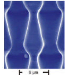
Abb. 5.15. Membran mit sägezahnförmigen Poren. Über einen Ratschenmechanismus können damit kleinste Partikel aufgetrennt werden.
