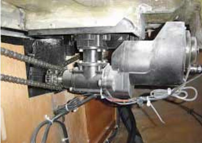
**Konstruktiv intelligent gelöst und sauber installiert; die Doppelsteueranlage der 50er. Gut zu sehen die Kettenübertragung auf die beiden Räder und die angeflanschte Selbststeueranlage.**
