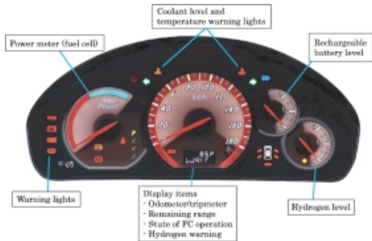
Fig. 6 MFCV meter cluster
