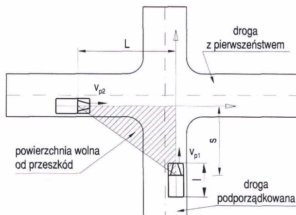
Rys. 3.2.21.2. Widoczność na zatrzymanie się przed skrzyżowaniem
