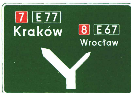
Rys. 6.3.1.2. Tablica E-1 przed trzypięciennym skrzyżowaniem dróg międzynarodowych
