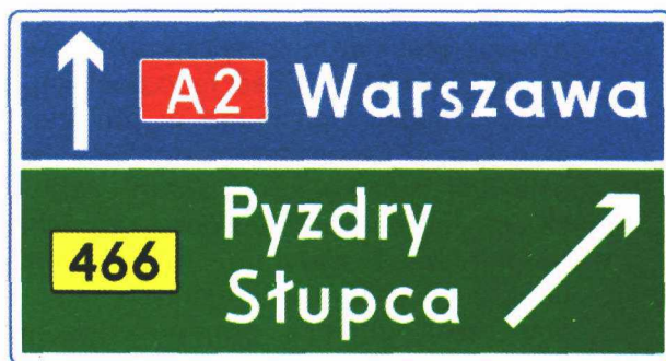
Rys. 6.3.2.5. Drogowskaz E-2c na autostradzie
