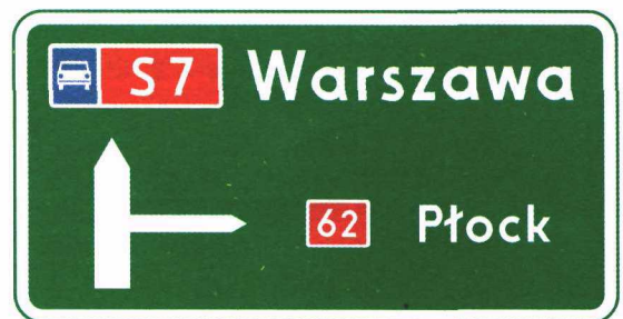
Rys. 6.3.1.7. Tablica E-1 na początku drogi ekspresowej
