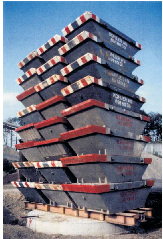
Belastungsversuch von Rüttelstopfsäulen über einer Grosslastplatte
