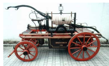
Bild 25: Saugfeuerspritze mit Wasserkasten Nr. 1750 für die Gemeinde Ergenzingen, hergestellt im Jahr 1886
