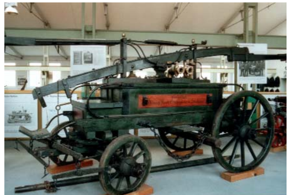
Bild 17: Feuerspritze von Christian Heinrich Kurtz, hergestellt im Jahr 1849, heute im Stuttgarter Feuerwehrmuseum
