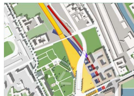
Lagen der Tunnel der Bahn, S-Bahn und U-Bahn mit geplanter Führung der B 96
