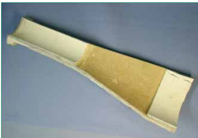
Bild 3: Grundsätzlich unterschiedlich formulierte Systemkomponenten aus PVC-C können immense Unterschiede im Korrosionsverhalten zeigen. Das Bild zeigt DEKADUR-C PVC-C Rohre zusammen mit einem Platten-Fremdfabrikat; die aus der Platte gefertigte Reduktion ist nach 4-jährigem Betrieb im Anolyt einer Chloralkali-Elektrolyse ( T=91^{\circ}\text{C} ; \text{pH } 4-5 ) komplett zersetzt worden.
