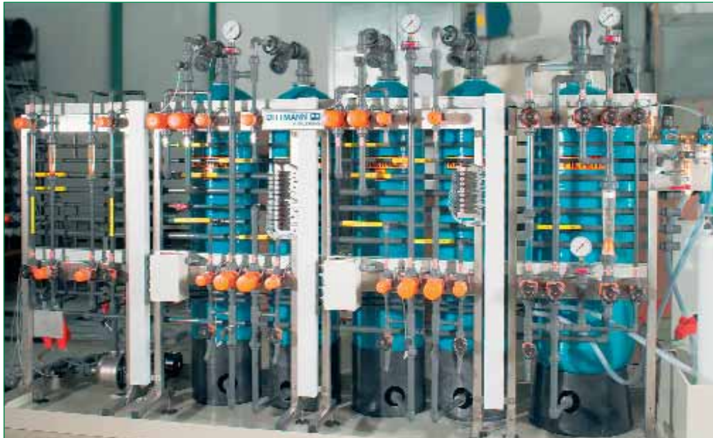
Bild 1: Ionenaustauscher-Anlage mit PVC-U-Komponenten
