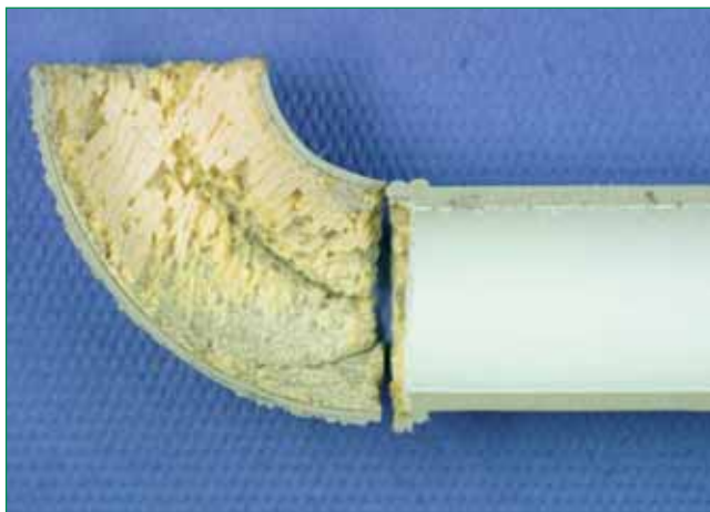
Bild 4 macht die Unterschiede in der chemischen Beständigkeit bei unterschiedlicher Materialauswahl und Verarbeitung innerhalb der PP-Werkstoffe deutlich. Das Bild zeigt Resultate aus einem 6-jährigen Betrieb einer PP-Druckrohrleitung im kontinuierlichen Kontakt mit 30 % Wasserstoffperoxid-Lösung bei T = 20-30^{\circ}\text{C} . Rohr: DEKAPROP Beta-PPH 32 x 2,9 mm; Formteil: PP-Copolymer Fremdfabrikat.
