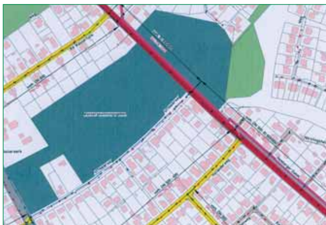
Bild 1: Auf Grund undichter Muffen musste eine neue Abwasserleitung durch ein Wasserschutzgebiet verlegt werden
