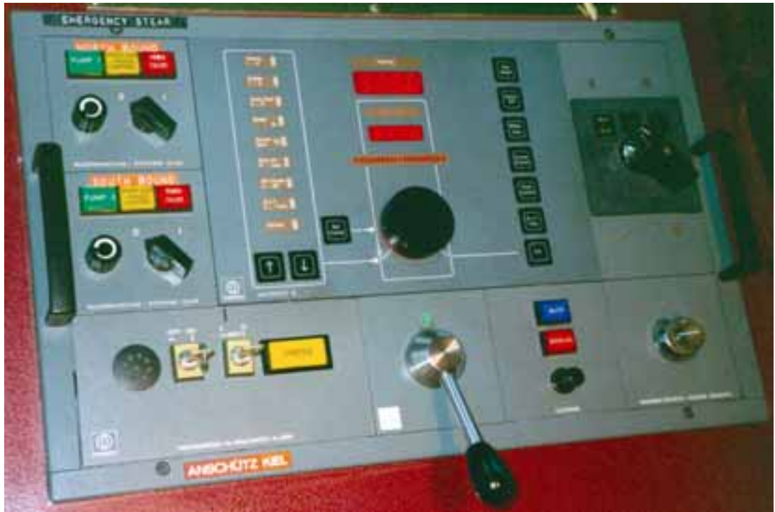
Kuva 4. NAJADENin autopilot ja vahtihälytin, avain paikallaan, kuva otettu 1999.
