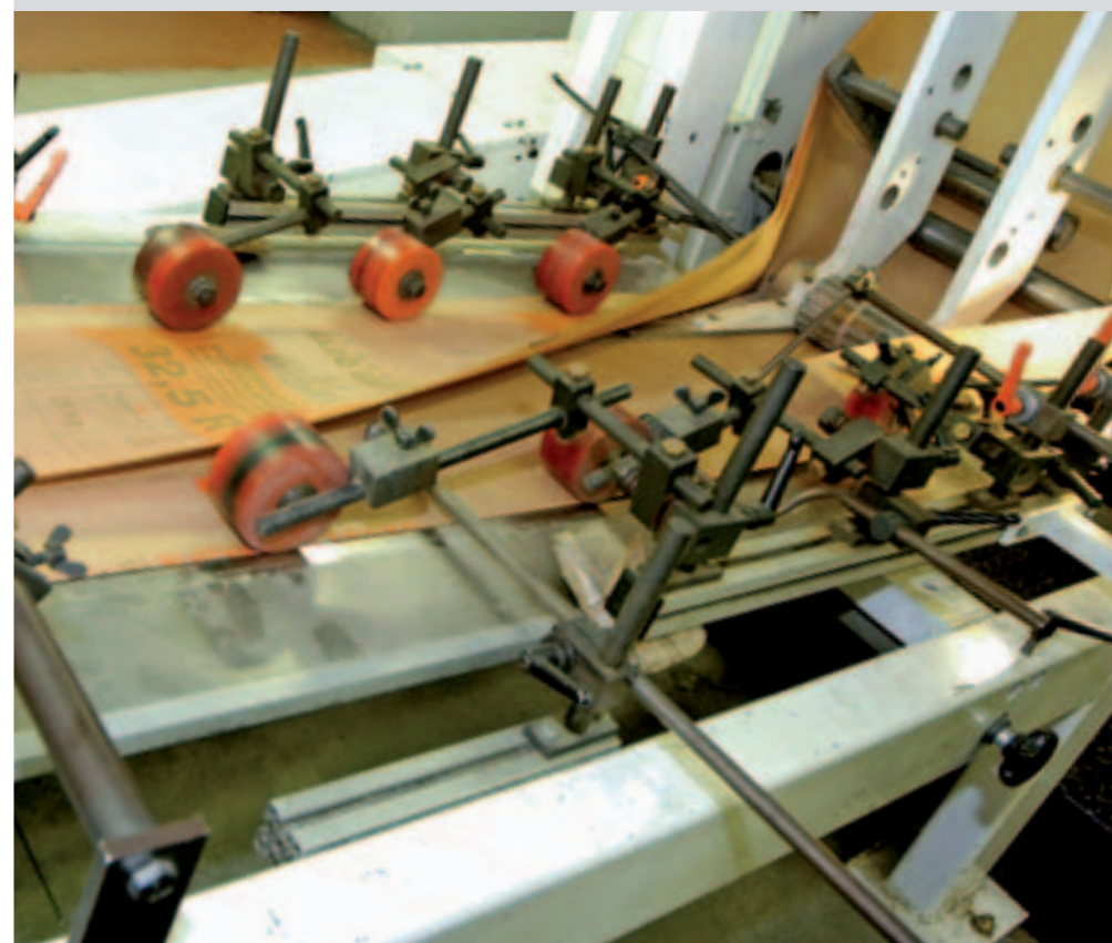
Dünn aber belastbar. UPM hat die Herstellung und Füllung von zweilagigen aus 60-Gramm-Papier bestehenden Zementsäcken testen lassen. Die Tests zeigen, dass das leichtgewichtigeres Papier genauso gut funktioniert wie die traditionelle Lösung aus 2x70.
