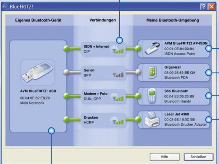
Jedes konfigurierte Gerät der Bluetoothumgebung wird als Objekt auf der Oberfläche angezeigt.
