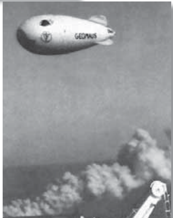
Fesselballon und Rauchfahne zur Luftschichtungsbeobachtung
