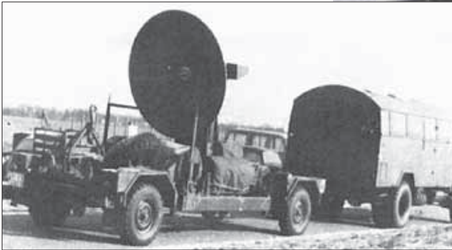
Höhenwind-Radargerät, 120 km Reichweite
