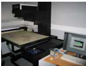
Kuva 24. Isokokoisten asiakirjojen kuten karttojen digitointiin käytettävä skannauslaite Kansallisarkistossa. Kuva: Mika Tukiainen.
