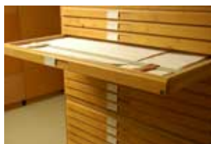
(suurempi kuva: 800x532 | 3008x2000 pikseliä) Kuva 12. Karttalaatikkojen etu- ja takaosassa olevat läpät tai tangot, joiden alle kartat tai piirustukset jäävät, pitävät aineiston paikallaan ja estävät sitä taittumasta. Kuva Fredrik Forssell.
