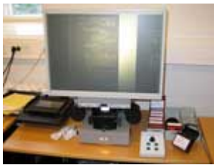
(suurempi kuva: 800x600 | 2592x1944 pikseliä) Kuva 21. Lukulaite, jolla voi lukea sekä rullafilmejä että kortteja. Irrotettava korttien lukualusta näkyy vasemmalla. Tietojen etsintää varten laite on ”motorisoitu” (säätölaite kuvassa oikealla). Mikrokorttien käsittelyssä suositellaan käytettäväksi puuvillakäsineitä. Kuva: Mika Tukiainen.
