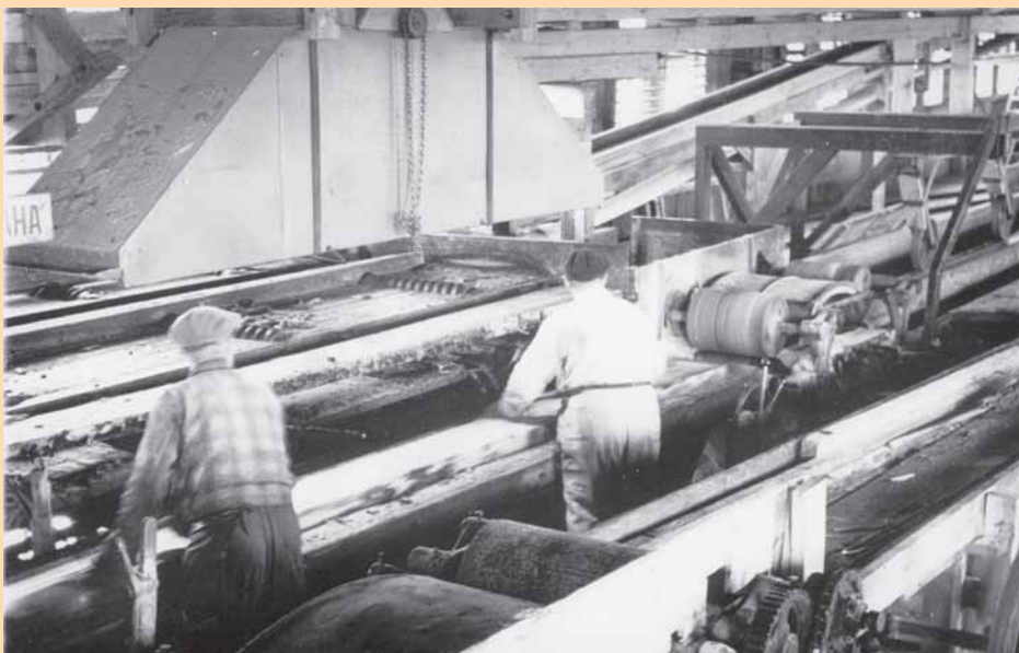
Särmäyssaha, sär- mäijinä Väinö Siitari ja Jaakko Varjoluoto. Etualalla näkyy "tup- la-raamin" särmäys- saha.
