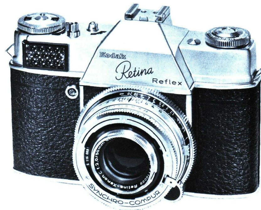
Abb. 21. Kodak-Retina-Reflex mit Schneider-Retina-Xenon C 1:2,0/50 mm. Reflex-Sucher mit formatfüllender Mattscheibe und optisch gekuppeltem Schnittbild-Entfernungsmesser. Synchro-Compur-Verschluß mit LichtwertEinstellung, Zeit-Blende-Kupplung, Sicherungsriegel für die Bajonett-halterung der Wechseloptik, Einstellsperre für Blitzkontakt und Selbstauslöser. Eingebauter Lichtwertmesser mit einem großen Meßbereich und Feinfixier-Zeiger.
