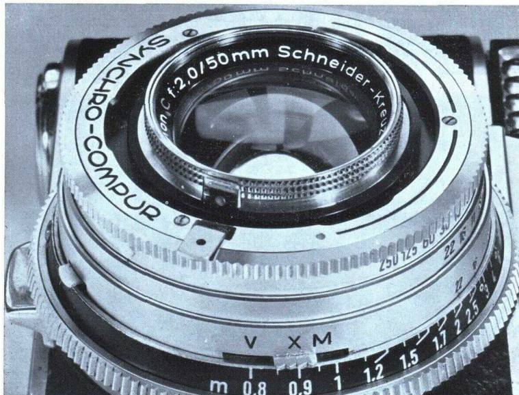
Abb. 25. Der Synchro-Compur-Verschluss mit Schneider-Retina-Xenon C 1:2,0/50 mm, Sicherungsriegel (rechts von der Gravur „Synchro-Compur“) für Bajonethalterung der Wechseloptik und Einstellsperre (unter dem Wort „Compur“ und direkt über der schwarzen Entfernungsskala) für Blitzkontakt XM und Selbstausslöser V.
