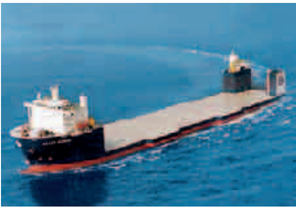
Tieflader der Meere: Das Lastenschiff „Black Marlin“ ist eines der weltweit größten Heavy-Lift-Vessels (HLV).
