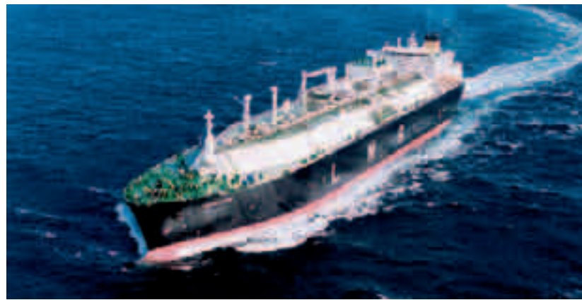
Komplexe Technik: Moderne Membrantanker sind komplizierte Konstruktionen mit so genannter Sandwichbauweise.
