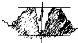
Figur 1. Principen för mätning av barksprickors djup (genomskärning av barklager). Mätningen sker från en tänkt linje mellan två intilliggande barktoppar till den djupaste punkten i sprickan.
